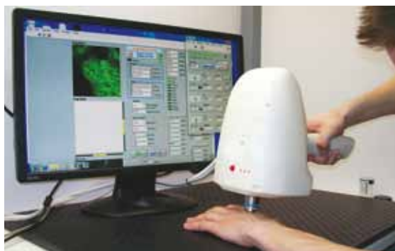
FiberScope, a kézben tartott nemlineáris mikroszkóp
