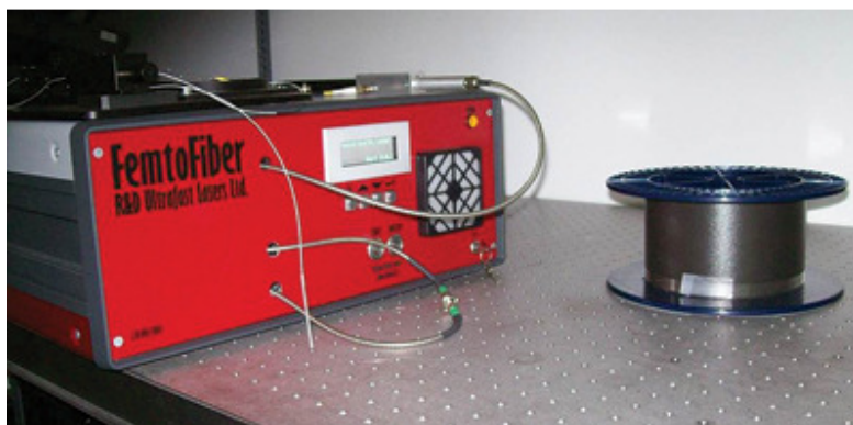
A FIBERSC2 projekt során kifejlesztett, ipari kivitelű, szálintegrált pikoszekundumos Yb-szállézer és erősítő rendszer
