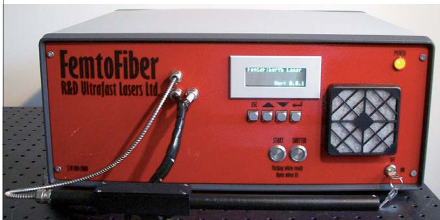
Az R&D Ultrafast Lasers Kft. FemtoFiber márkanévű femtoszekundumos Yb szállézer-erősítő rendszere ( \lambda \sim 1030 nm, P_{\text{átl}} \sim 1 W, \tau \sim 300 fs, \nu \sim 20 -60 MHz)
